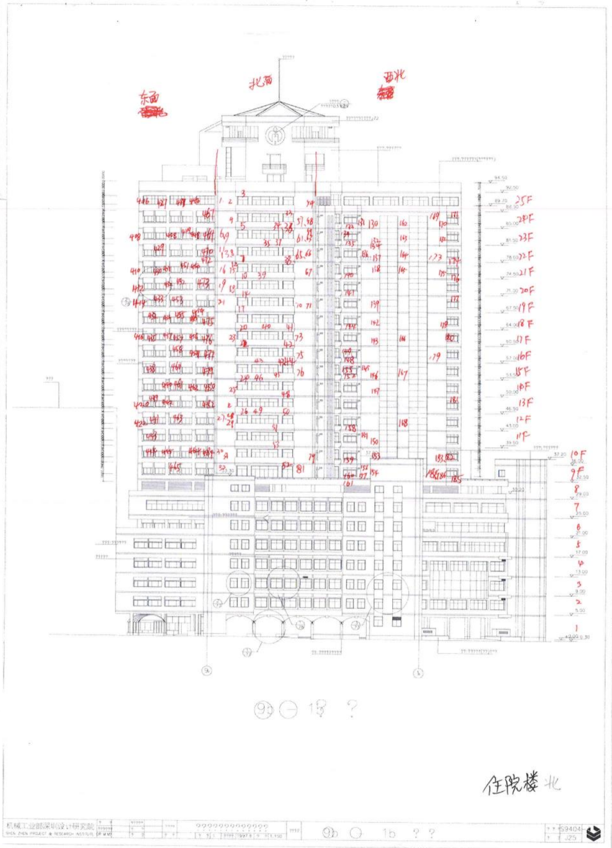
图8-8 门诊住院大楼东面、北面及西北面外墙瓷砖缺陷位置示意图
