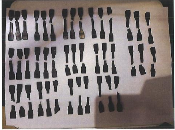
图 4-36 完成试验的哑铃型胶样
