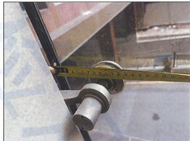
图6-16 玻璃面板支承孔边与板边距离测量
