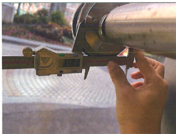
图 6-2 内侧夹板直径测量
