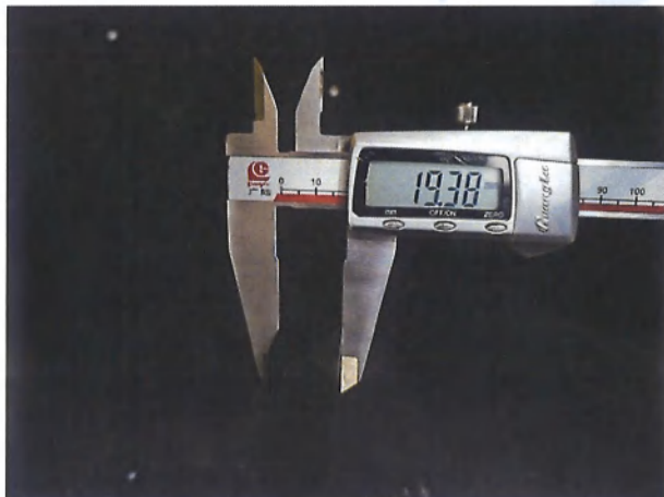
图 5-20 结构胶宽度测量
